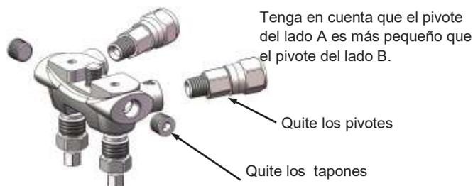
5. Aplique sellador de roscas a los tapones que retiró en el paso 3 y vuelva a instalarlos como se muestra. Utilice los codos del kit de entrada inferior e instálelos como se muestra con sellador de tuberías o cinta de PTFE en las roscas. Ensamble los pivotes giratorios a los codos. Asegúrese de que el pivote más pequeño esté en el lado A. Vuelva a conectar las mangueras A y B asegurándose de que todos los componentes A y B estén en el lado correcto.
