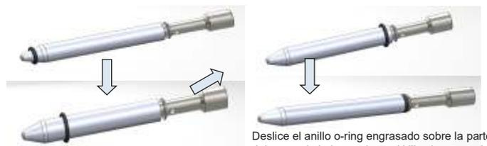
Deslice el anillo o-ring engrasado sobre la parte delantera de la herramienta. Utilice la uña en la tierra para posicionar la herramienta. Deslice el o-ring a su posición.
